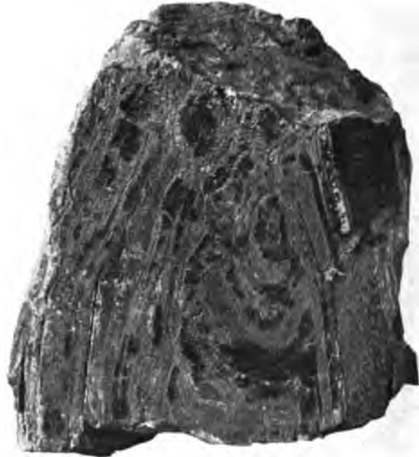
Fig. 69. Itabirite von Krivoi Rog, bestehend aus abwechselnden Lagen von Quarzit (hell) und Roteisen (dunkel).
